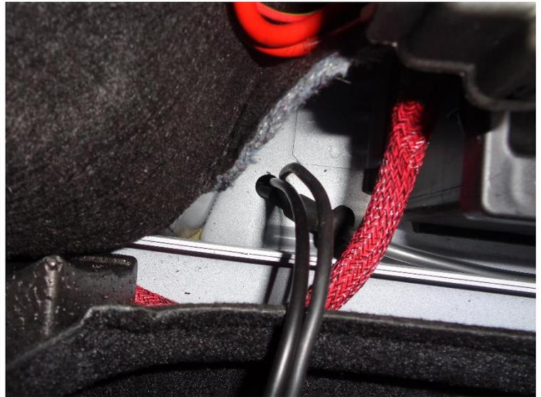
Den Aufkleber vom Träger auf der rechten Fahrzeugseite entfernen und einen Kabelbinder im Fahrzeugträger positionieren.
