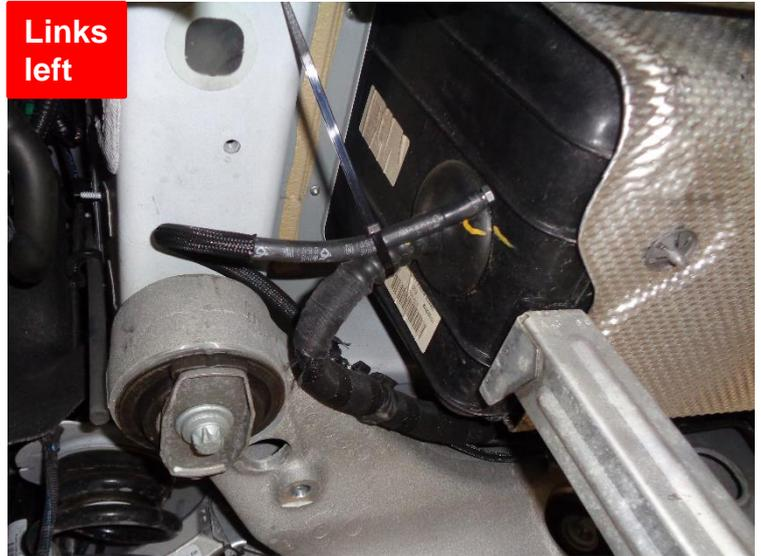
Die REMUS Aktuatorenkabeln an den Aktuatoren anschließen.
