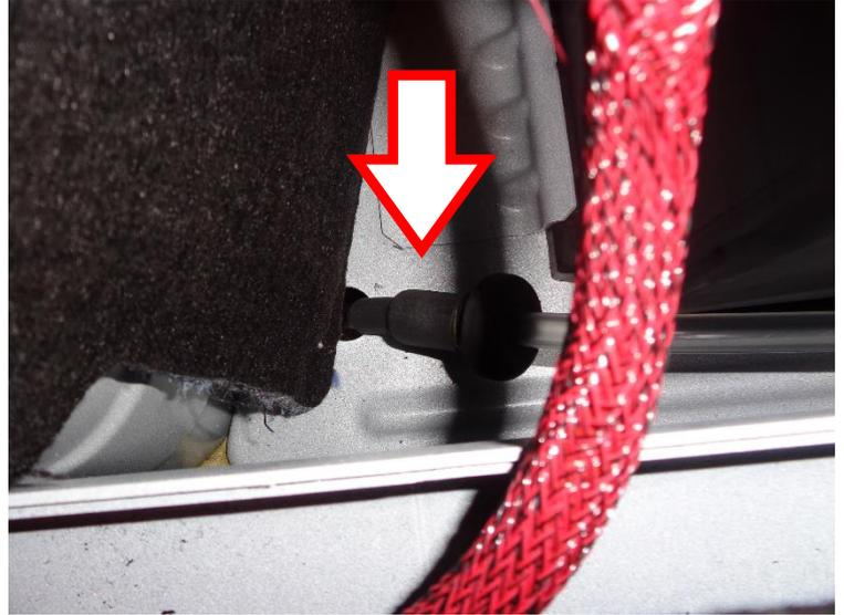
Das Hitzeschutzblech über dem Schalldämpfer lösen. Das längere REMUS Aktuatorkabel von der linken Klappe beginnend unter dem Hitzeschutzblech bis zur Öffnung des Batterieschlauchs verlegen.
