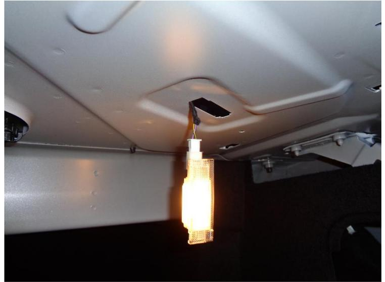
Den roten und schwarzen Draht des REMUS Zuleitungskabels hinter der Verkleidung verlegen. Den roten Draht zur Kofferraumleuchte führen.
